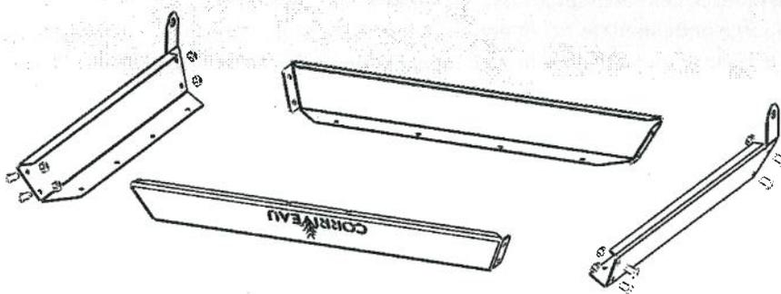
Étape 6 : Boulonner le grillage du couvercle #H en utilisant les boulons #L 1/2" long, rondelle plate #O et écrous #M. Serrer les boulons à la main seulement.
