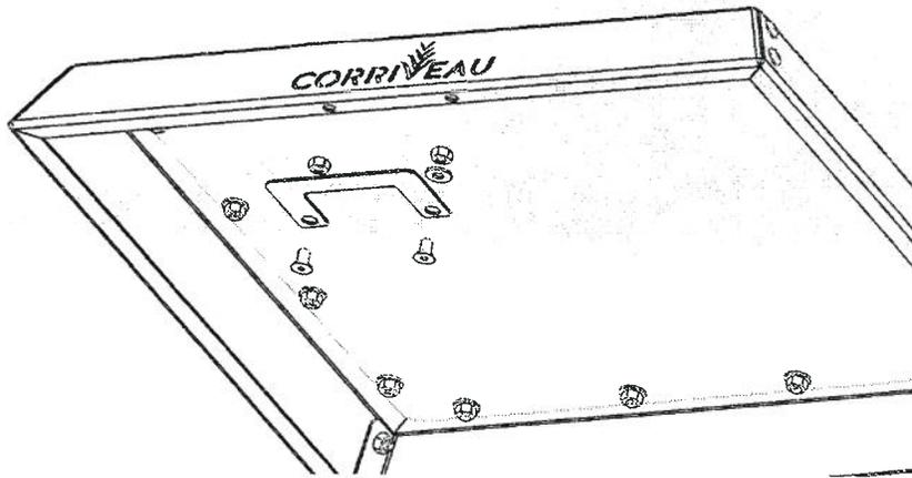
Étape 8 : Installer le couvercle assemblé sur le foyer en utilisant les boulons #P 3/4" long, rondelle de charnière #J, rondelle plate #O et écrous #M. S'assurer que la rondelle de charnière #J est bien positionné dans le trou de charnière du couvercle avant de serrer le boulon et l'écrou.
