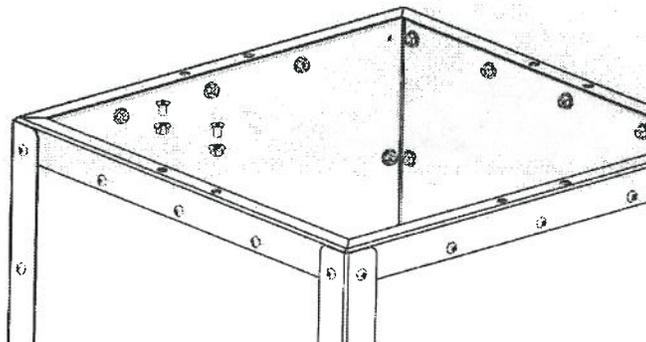
Étape 5 : Boulonner les 4 parties du couvercle #E, #F, #G, #I (i), avec les boulons #L et écrous #M. Serrer les boulons à la main seulement.
