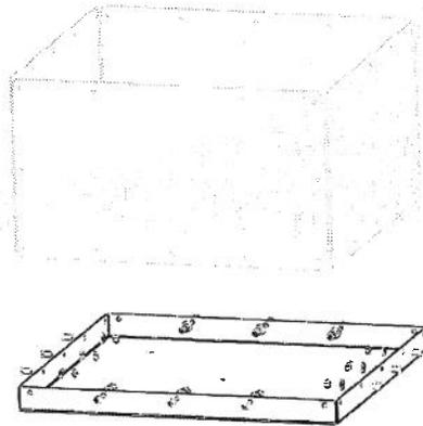
**Étape 2 :** Boulonner les pattes #B sur le fond et les grillages de pourtour. Utiliser des boulons #L  $\frac{1}{2}$ " long, rondelle plate #O et écrous #M. Mettre les boulons dans les trous inférieur et central seulement. Serrer les boulons à la main seulement.
