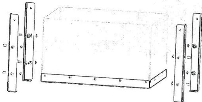
**Étape 3 :** Boulonner les contours supérieurs #C en utilisant les boulons #L  $\frac{1}{2}$ " long, rondelle plate #O et écrous #M. Garde 2 coins opposé sans boulons pour les charnières du couvercle. Serrer les boulons à la main seulement.
